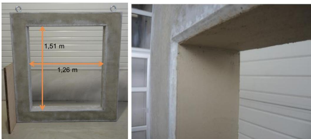
Abbildung 2: Bild des Standard-Prüfkörpers Dichtbetonwand mit Glattstrich
